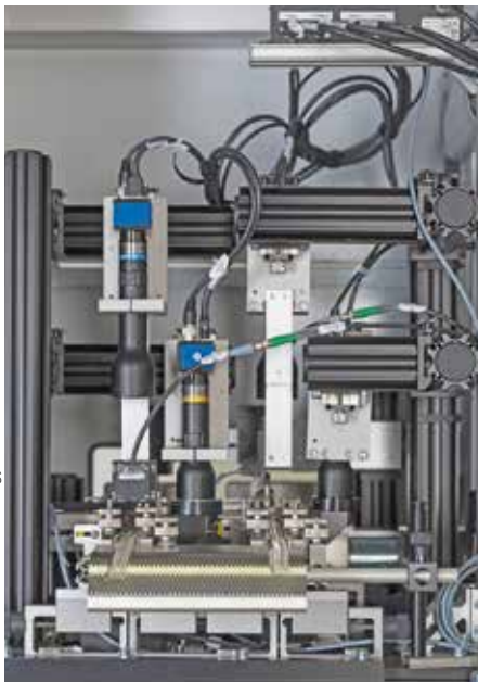
Eine PSS-40-Prüfstation mit doppelter Technik und vier Kameras zur parallelen Prüfung von zwei Stanzstreifen.
