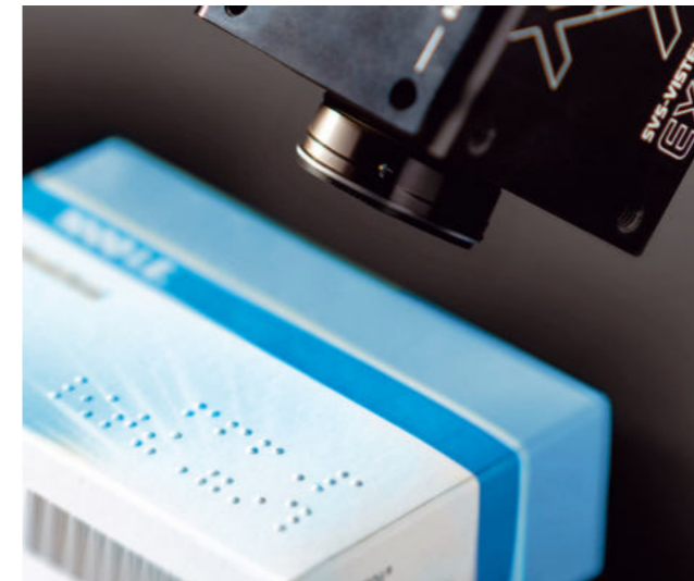
Kameras von SVS-Vistek in Dotscan-Systemen von In-situ ermöglichen die zuverlässige Überprüfung von Braille-Schriften auf Medikamentenpackungen.
