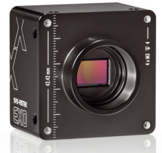
Die in den Exo-Kameras von SVS-Vistek integrierte Beleuchtungssteuerung spart Hardware-Kosten und reduziert die Integrationszeit. © SVS-Vistek
